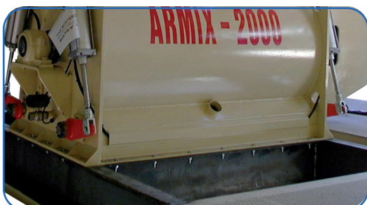
Imagen 4. Marco de apoyo para enlace con tolvas de descarga
